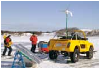
間宮海峡横断に挑戦した「ARK-1」号。 ソーラーパネルと風車を使って充電中。 （写真＝ZEVEX提供）
