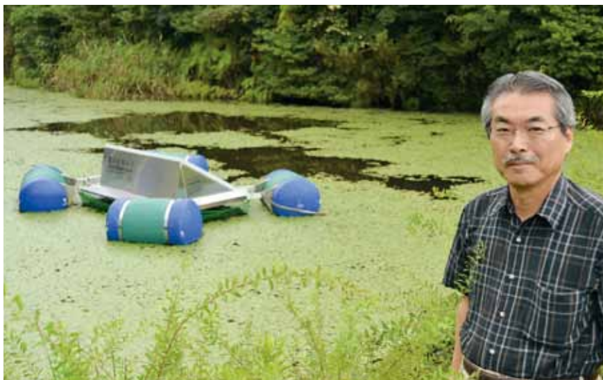
BKC内の自然池で実証実験を行なっているナノバブル発生装置
