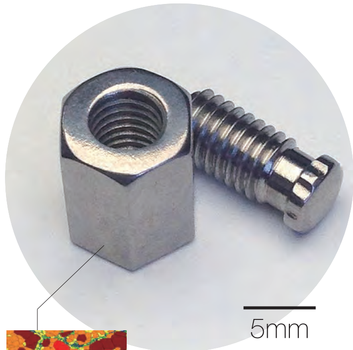
調和組織制御により作製した純チタン製ボルト・ナットとその顕微鏡写真。微細結晶粒のネットワーク構造が粗大結晶粒を包み込んでいる様子がわかる。
