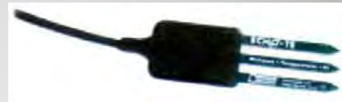
メイワフォーシスKK.カタログより (土壌水分、塩分濃度、温度を測定) サイズ: 10Lx3.2wx 0.7t(cm)
