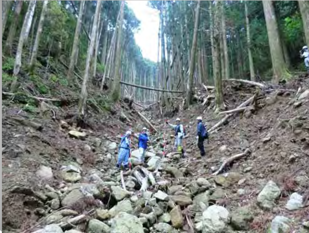
写真3 熊野那智大社 大社裏山の土石流跡 中間地点 傾斜角20度程度の既存の谷を押し広げるように発達
